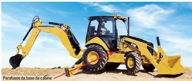
Parafusos da base da cabine
