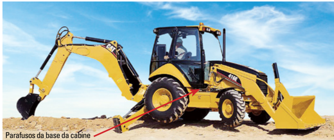
Parafusos da base da cabine
